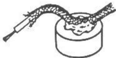
Bild 4: Koaxialkabel, dessen Geflecht auf´s Potengehäuse gelötet ist.
